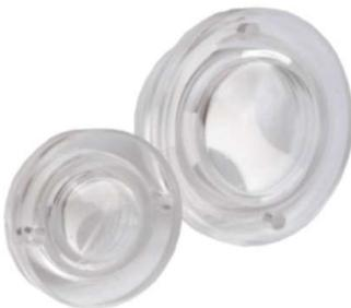
Estos visores están disponibles con reflector blanco. Los de Poliacrílico resisten hasta 70°C y una presión de trabajo de hasta 2 bar. La alternativa en Policarbonato resiste hasta 120°C. Disponible en conexiones 1/4", 3/8", 1/2", 3/4", 1" y 1-1/4". No están diseñados para trabajar con alcohol, solventes, Benceno y otros fluidos.
