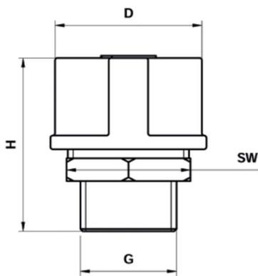
Los Venteos están diseñados para prevenir las variaciones de presión en sistemas cerrados tales como reductores, cajas de descansos, etc. Permiten mantener una presión constante. Fabricados en Acero Inoxidable 316L, protegen contra el ingreso de polvo y agua de acuerdo a IP 34.
